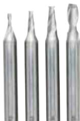
Tutte con codolo cilindrico da 6 mm. Un pezzo delle seguenti misure: 2 - 3 - 4 e 5 mm. Due taglienti secondo norma DIN 327. In cassetta di legno con coperchio scorrevole.
