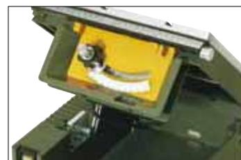
Per la pulizia della macchina e per la sostituzione della lama il tavolo con il gruppo motore possono essere aperti e bloccati come il cofano di un'automobile.
