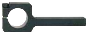
**In acciaio 30 x 10 x 65 mm. Per un sicuro e preciso bloccaggio di un trapano-fresatore:** ad esempio il LB/E o IB/E nella torretta portautensili del tornio. Foro di fissaggio Ø 20 mm sistema MICROMOT. Gambo 8 x 8 mm per i portautensili del PD 230/E e PD 400.
