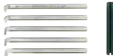
Utensile per filettatura metrica 60° e whitworth 55°. Un incisore da 1,3 mm uno da 2,65 e uno da 4 mm. Codoli 6 mm. Lunghezza totale 95 mm. Gli utensili vanno inseriti nel portautensili accluso e fissati nella torretta portautensili del PD 230/E. Confezionato in cassetta di legno.
