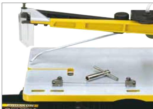
Blocchetti portalama brevettati con elevata capacità di serraggio garantiscono un preciso allineamento della lama. Appositi incavi nel piano di lavoro stabiliscono la posizione e la distanza dei bloccetti facilitando il montaggio della lama.
