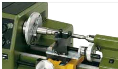
**Attrezzatura per tornire tra le punte. Per lavorazioni estremamente precise ad elevata coassialità.**
