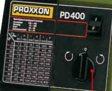
Manopola per il comando dell'avanzamento automatico.
