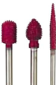
**Impareggiabili per modellare, pulire e lisciare legno e fibra di vetro.** Dal tagliante estremamente vivo e facili nell'impiego. Il materiale si lascia asportare in modo controllato senza uso della forza, indifferentemente se con o contro la venatura del legno. Elevata durata, facile pulizia con il bruciatore a gas MFB/E. Adatte anche per gomma, gomma-schiuma e silicone. Velocità d'impiego tra 5.000 e 20.000 giri/min. Codoli d. 3,2 mm. Da NON usare su metalli!
