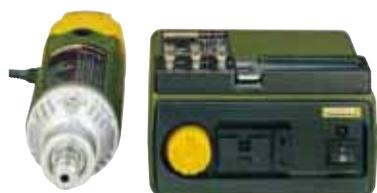
Alimentatore con regolazione elettronica ad onda piena da allacciare alla 220 - 240 V. Tensione in uscita 40 Volt corrente continua. Massima potenza assorbita 250 W. Numero di giri registrabile in continuo da 900 a 6.000/min. Peso kg. 4,2. In dotazione pinze di serraggio 2,35 - 3,0 -
