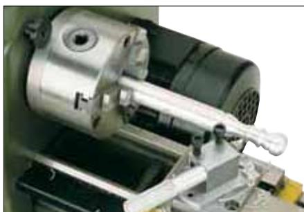
**Per i sistemi PD 230 e PD 400.** Si monta al posto della torretta portautensili sulla slitta trasversale. Per la lavorazione di forme convesse e concave. Per lavorare su acciaio (profondità del truciolo fino a 1 mm) su metalli non ferrosi e materie plastiche. Consente la tornitura di raggi o 3/4 di sfera fino a 32 mm. In dotazione uno scalpello a punta 8 x 8 x 80 mm. In cassetta di legno con coperchio scorrevole.
