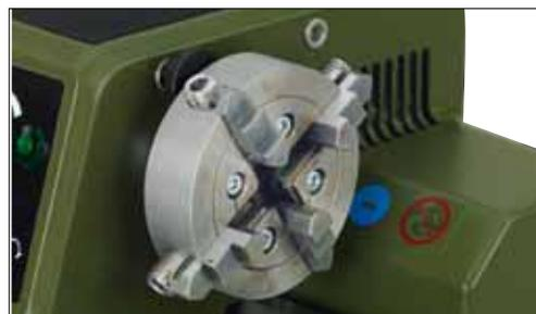
**Mandrino a 4 griffe con griffe singolarmente impostabili.** Per serrare pezzi spigolosi e dalla forma asimmetrica. Capacità di serraggio fino a 80 mm.
