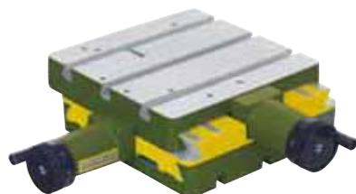
2 mm di avanzamento. 1 tacca = 0,05 mm di avanzamento. Piano di lavoro rettificato. Tre scanalature a T passanti per il fissaggio di morse e dispositivi di fissaggio. Un'arresto con battute prestabilite anche per 45°. Viti di fissaggio e un morsetto in dotazione. Piano di lavoro 200 x 200 mm. corsa massima 150 x 150 mm (150 x 76 mm quando il tavolo a croce viene montato come qui raffigurato). Altezza 75 mm. Peso 4,9 Kg. Le staffe di serraggio raffigurate a destra NON sono in dotazione.
