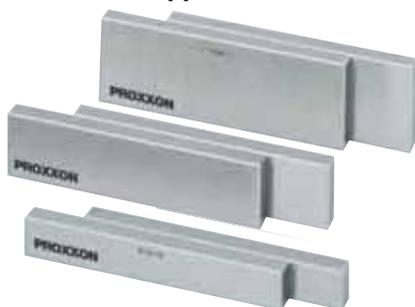
**Per lavori di impostazione su trapani, torni e fresatrici.** In lega di acciaio bonificato e temperato (58 – 62 HRC). Precisione parallelismo 0,002 mm. Due pezzi di ogni misura 8 x 10, 15, 20, 25, 30, 35 e 40 mm. Lunghezza 100 mm. Confezionati in cassetta di legno.
