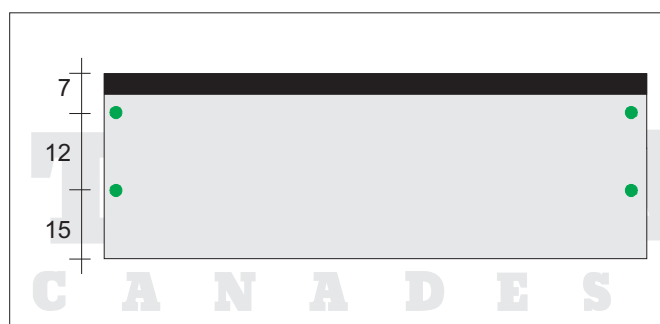
Fig. 5 - Chiodatura della prima fila di tegole
