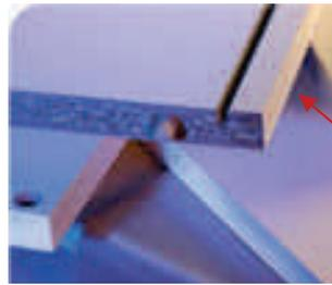
La lavorazione di fresatura per incasso fodere trova impiego, in alternativa al battente, nella realizzazione di fianchi di librerie, armadi e in tutti i mobili che necessitano di schiena.
