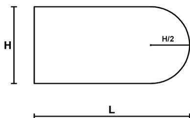
Forma tipica impiegata in trompe d'oeil o pannellature consistente in una parte ad arco avente raggio di curvatura pari alla metà del lato.
