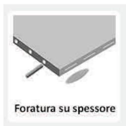
La foratura sugli spigoli del pannello, dei tre tipi sotto indicati, può essere effettuata per inserire perni o giunti (rasfix, rastex), lamelli e ferra-
